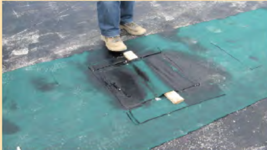
1 a fase: preparazione del provino 50x50 (tagliato con cutter al centro del rotolo) su massetto trattato con primer.
