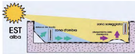
L'irregolare insolazione della copertura può determinare, nelle zone d'ombra, distacchi dei risvolti, e in quelle soleggiate fenomeni di allungamento della membrana con conseguenti distacchi dal supporto.
