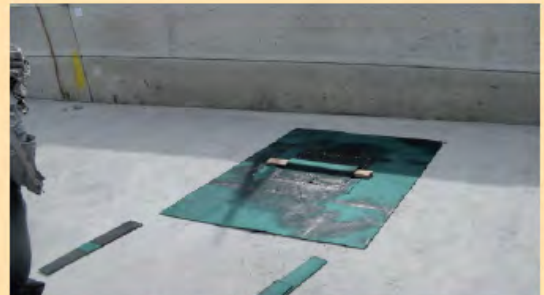
4 a fase: preparazione del provino 50x50 (tagliato con cutter al centro del rotolo) su massetto non trattato con primer; estrazione del provino (la forza esercitata è stata di due persone (quindi \geq 50 kg), ma non è stato possibile sollevare il riquadro).
