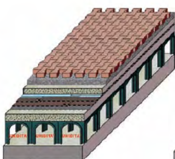
Solaio con intercapedine con un solo livello di impermeabilizzazione (l'acqua presente nel vuoto dell'intercapedine può bagnare il solaio strutturale gocciolando a plafone negli ambienti sottostanti).
