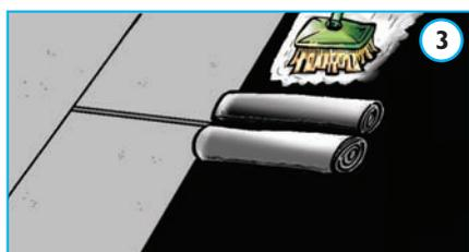
Nella modalità per incollaggio, i teli così posizionati vanno poi ripiegati longitudinalmente su se stessi per metà della propria larghezza **(dis. 4)** (o riavvolti da entrambe le estremità verso il centro **dis. 3**), in modo da scoprire la corrispondente parte del piano di posa su cui stendere a mezzo spazzolone l'adesivo ADITHENE (1 kg/m<sup>2</sup> circa).
