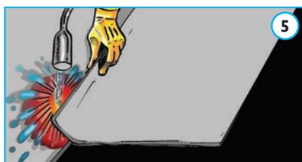
Si ripetono le medesime operazioni per l'incollaggio dell'altra metà del telo, e si saldano le giunzioni laterali e di testa con procedimento a fiamma o con idoneo erogatore ad aria calda.
