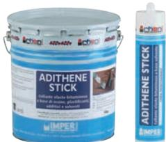
Collante elasto-bituminoso a base di resine, plastificanti, additivi e solventi. Ideale per l'applicazione delle tegole bituminose. Specifico per le sovrapposizioni di testa delle membrane adesive ardesiate della serie **STICKER** e per l'incollaggio a freddo delle membrane bituminose sulle parti verticali e sui sormonti.
