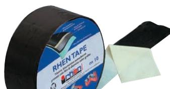
Nastro bituminoso autoadesivo autoprotetto costituito da una massa elastoplastica impermeabile bituminosa rivestita da un film metallico di color grafite. Sigilla parapetti, lucernari o infissi.
